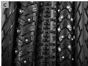
Per montare un nuovo pneumatico è necessario prestare attenzione al sistema e alla dimensione dello pneumatico montato fino ad ora. Le dimensioni sono riportate in due unità sul fianco del pneumatico: la più precisa è la denominazione in millimetri standardizzata (esempio: 40-622 **(d)** indica una sezione del pneumatico di 40 mm in stato gonfio ed un diametro (interno) del bordo del pneumatico di 622 mm). L'altra unità è in pollici (ad es. 28x1,5").
