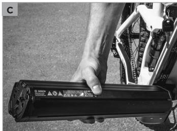
Se il rivestimento esterno della batteria è danneggiato potrebbero entrare acqua e umidità provocando un corto circuito o una scossa elettrica. La batteria potrebbe infiammarsi o persino esplodere! In questo caso rivolgetevi immediatamente ad un rivenditore specializzato SCOTT. Potrete trovare maggiori informazioni consultando le istruzioni per l'uso del produttore del motore.
