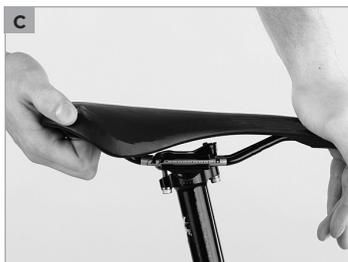
Montare il telaio negli elementi di bloccaggio interni, inserire nuovamente gli elementi esterni e la vite di bloccaggio. Nel caso in cui il telaio dovesse essere troppo aperto non tentare di posizionarlo nelle scanalature di fissaggio premendo con forza. Il meccanismo di bloccaggio o il telaio potrebbero rompersi, causando un incidente e/o ferite gravi al ciclista.
