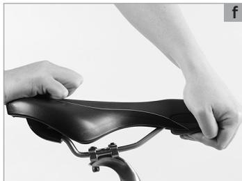
Nel caso di **dispositivo di bloccaggio integrato al reggisella (a)** con due viti di bloccaggio posizionare una dietro l'altra, allentare entrambe le viti con max. due-tre giri, altrimenti potrebbe aprirsi l'intero meccanismo. Spostare la sella orizzontalmente per regolare la distanza dal manubrio. Spesso è necessario dare un piccolo colpo alla sella. Fare attenzione alle marcature sul telaietto, che non devono essere superate.
