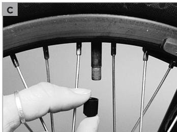
Nel caso della **valvola Presta**, prima di pompare è necessario svitare leggermente il dado zigrinato e premerlo brevemente verso la valvola, fino a far uscire un po' d'aria. Verificate la tenuta del corpo della valvola sul tubo. Se non è serrato correttamente è possibile che l'aria fuoriesca lentamente. Non dimenticate di richiudere bene il dado della valvola dopo aver gonfiato la camera d'aria.
