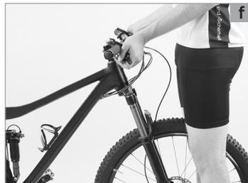
Se necessário, alinhe os componentes e aperte cuidadosamente os parafusos até os componentes ficarem fixos de forma segura **(a)**. Encontrará os binários máximos de aperto dos parafusos impressos nos componentes ou nas instruções dos fabricantes dos componentes.
