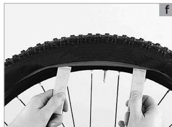
Se uma parte do flanco do pneu estiver levantada por cima do friso do aro, consegue-se, normalmente soltá-lo facilmente a toda a volta, deslocando uma alavanca de montagem.
