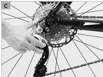
Através deste ajustamento, evita que a corrente caia entre o pinhão e os raios ou o desviador traseiro ou a sua caixa das roldanas de guia possam tocar nos raios – doutra forma os raios, o desviador traseiro e o quadro poderiam ficar danificados. Na pior das hipóteses pode dar-se uma queda ou acidente.
