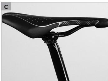
Se o selim ficar bem, aplique-o no espigão de tal maneira que a armação fique presa no meio pelo mecanismo de fixação do espigão. Além disso, ajuste a aresta superior do selim paralelamente ao chão. Aperte o parafuso pouco a pouco e certifique-se que
