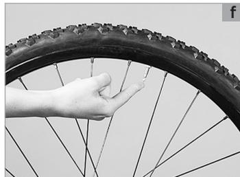
Para ter a certeza que a câmara de ar não está esmagada, faça deslizar o pneu a toda a volta para a frente para trás. Controle também desta forma, se a fita de aro se deslocou.
