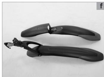
Guarda-lamas de montagem posterior para montagem fixa são em regra de plástico e são fixos na posição correta por meio de escoras instaladas adicionalmente. O comprimento da escora é ideal, se a aresta inferior da proteção da roda estiver colocada com uma distância de aprox. 15 mm em forma circular paralelamente ao pneu. Verifique se nem os travões nem o guiador são prejudicados por isso.
