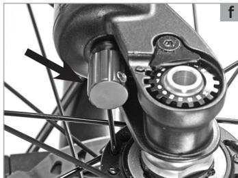
Um amortecimento mais fraco garante um bom comportamento de reação, mas provoca em certos casos que o garfo da suspensão realize, ao passar por cima de obstáculos demasiado depressa, uma compressão demasiado forte ou que baloie na condução em pé. Um amortecimento demasiado forte torna a suspensão dura, reduz assim o conforto da condução.
