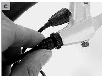
Como alternativa, o cabo pode ser ajustado da mesma forma diretamente no travão. Depois do reajuste, controle o funcionamento e se os calços não apresentam atrito, quando larga a manete do travão e faz girar a roda **(d)**. Se proceder a vários reajustes, a posição da alavanca na pinça do travão altera-se. O efeito de travagem torna-se mais fraco. Em casos extremos, o travão pode falhar por completo. Perigo de acidente!
