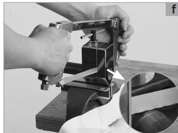
6. Rode o expansor com uma chave allen de 8 mm com um binário de aperto de no máximo 4-5 Nm. Assegure-se que o expansor está nivelado com a aresta superior do tubo **(a)**. Assegure-se de que a distância entre a aresta superior do aperto do avanço e a aresta superior do tubo não é superior a 2,5 mm, ver figura.
