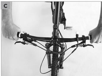
Aperte em seguida uniformemente, um após outro, os parafusos em cruz, isto é, alternadamente, e passo a passo, até atingir, com a chave dinamométrica, o limite inferior dos binários de aperto aconselhados.
