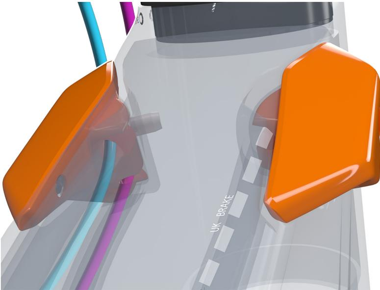
Se è la leva sinistra ad azionare il freno posteriore (solo Regno Unito), fai passare il cavo sul lato trasmissione del tubo sterzo (linee tratteggiate).
