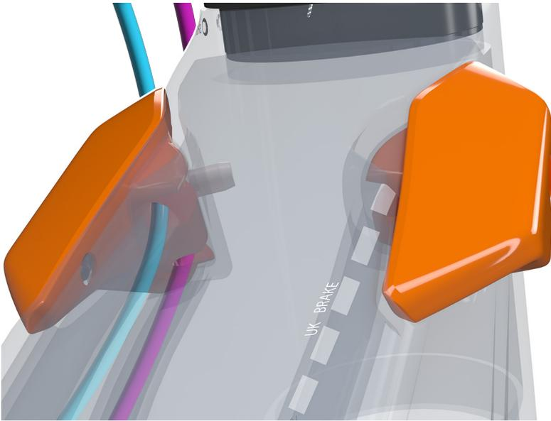
Si le frein arrière doit être actionné avec le levier de gauche (Royaume-Uni uniquement), veuillez utiliser le passage de câble côté roue libre (indiqué par les lignes pointillées).
