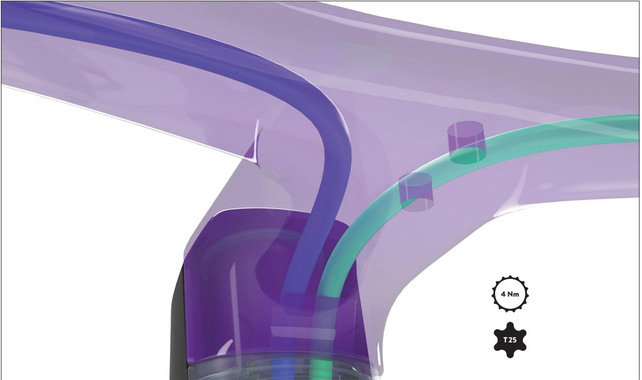
**04** Le câble du guidon combiné est installé de la même manière que la tige et le guidon standard, à l'exception du cache-câble. A l'intérieur, le chemin du câble est le même.
